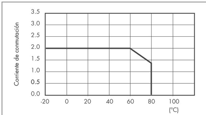
**L 34 - Corriente de conmutación en función de la temperatura ambiente**
