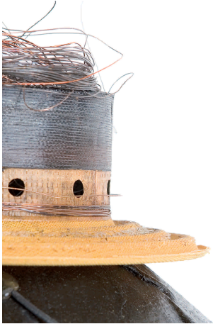
Típico centrador doble de algodón tratado con silicona.
